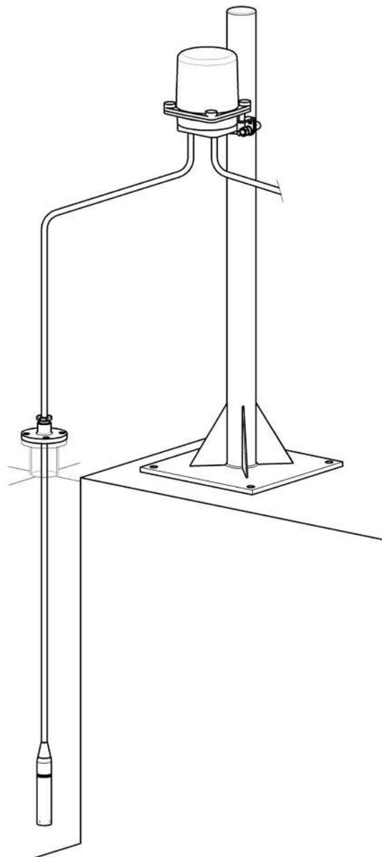
※水位計至近に配線用の中継 BOX を設けた例
