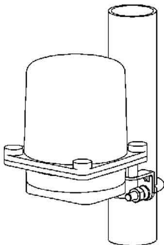
JTW-1 型は投げ込み式水位計の中継端子箱です。43AL シリーズ同様大気圧導入口を備えており、水位計ケーブルを直接結線できます。
