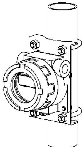
43ALW1 シリーズは、投げ込み式水位計の DC4-20mA ループ途中に挿入できるデジタル表示器です。
